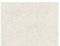
"Fermacell" plaque de gypse renforcé de papier recyclé pour cloisons isophoniques et coupe feu
